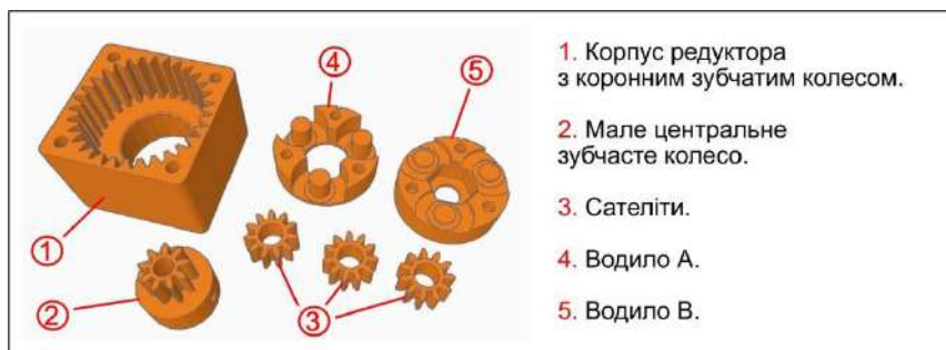
Рисунок 2. Редуктор планетарного механізму 1:4, розроблений в ресурсі Tinkercad.
